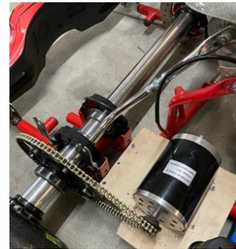
Abbildung 6: Antrieb mit verschweisstem Ritzel
