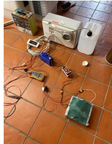
Abbildung 15: Verschaltung Brennstoffzelle mit Hauptakku
