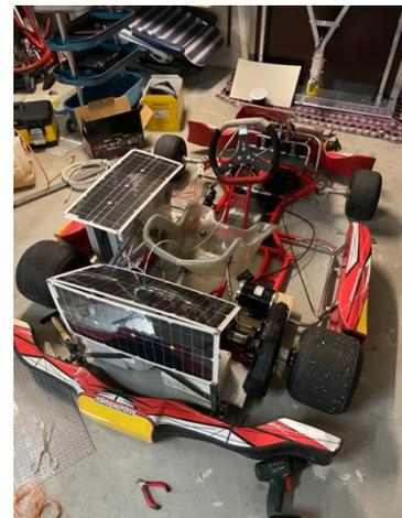
*Abbildung 14: Suboptimale Ausrichtung der Solarzellen*
